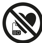
Les personnes porteuses d'un stimulateur cardiaque ou d'autres implants médicaux doivent se tenir à au moins 50 cm de distance du système
